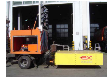
<그림 16> TMA (Truck Mounted Attenuator) : 트럭장착용 충격흡수장치
