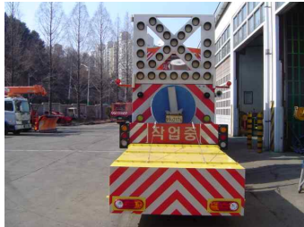
<그림 16> TMA (Truck Mounted Attenuator) : 트럭장착용 충격흡수장치
