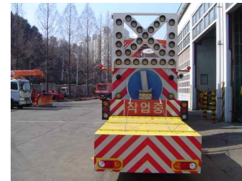
<그림 16> TMA (Truck Mounted Attenuator) : 트럭장착용 충격흡수장치
