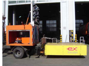
<그림 16> TMA (Truck Mounted Attenuator) : 트럭장착용 충격흡수장치
